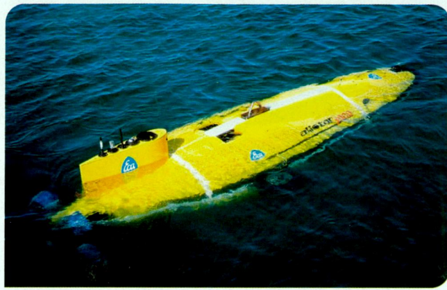
Alistar 3000, premier robot sous-marin d'inspection autonome au monde.
