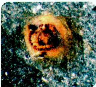
Section polie de sol montrant la présence d'oxyde de fer autour d'un conduit racinaire et au sein même des cellules constitutives de la racine. Des analyses chimiques réalisées par ailleurs mettent en évidence le fait que les oxydes de fer sont porteurs de métaux lourds comme le cuivre et l'uranium. La mise en œuvre de NanoSims 50 sur cet objet permettrait de préciser la localisation exacte des métaux dans la structure.
