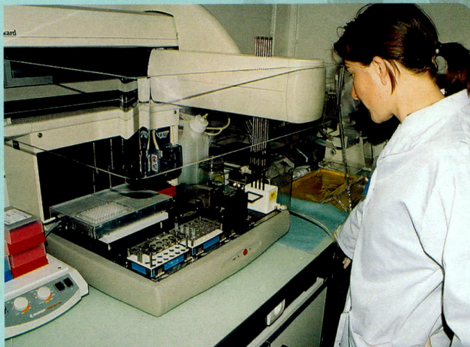
Robot de criblage permettant de tester sur des cellules ou sur des cibles protéiques une multitude de produits chimiques.
