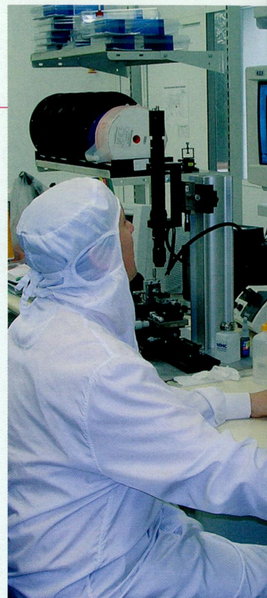
Le travail en salle blanche, garantissant une très faible quantité de poussières, permet de réaliser des modules optiques de meilleure qualité.
