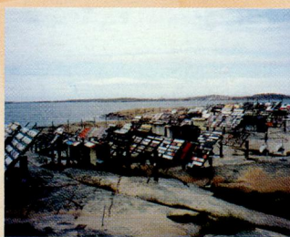
Les tests de corrosion se déroulent sur des "racks" où sont exposés des échantillons de matériaux traités de différentes manières.
