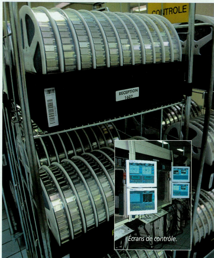
Les composants, dont la plupart viennent d'Asie, sont conditionnés sur des rouleaux de plastique.
