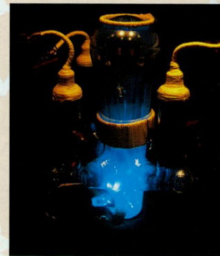
Lampe à mercure. Ici, ce sont les vapeurs de mercure qui conduisent le courant.
