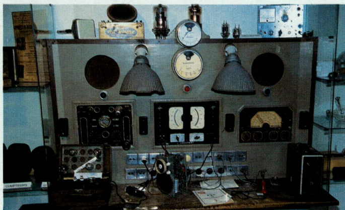
Lampemètre, appareil qui servait autrefois à tester la qualité des lampes (Électrothèque de Saint-Aignan).
