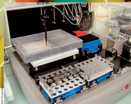
Sur la plate-forme de criblage haut débit, le robot de criblage recherche des molécules ayant un effet sur une cible, généralement une protéine.
