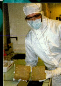
Matthieu Denoual tient un moule en résine qui sert à la fabrication de biopuces en matériaux polymères.
