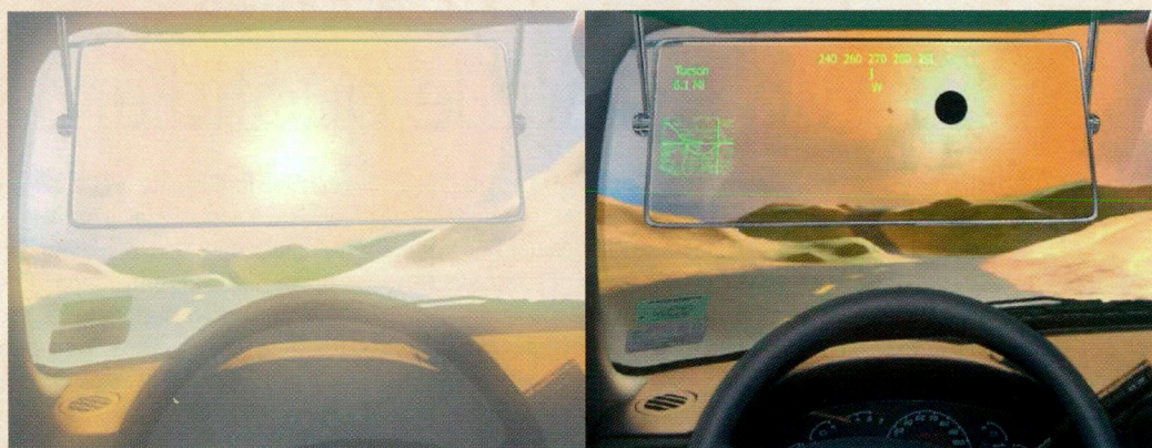
Le pare-soleil intelligent s'opacifie uniquement dans la zone sur laquelle la source de lumière devient gênante.
