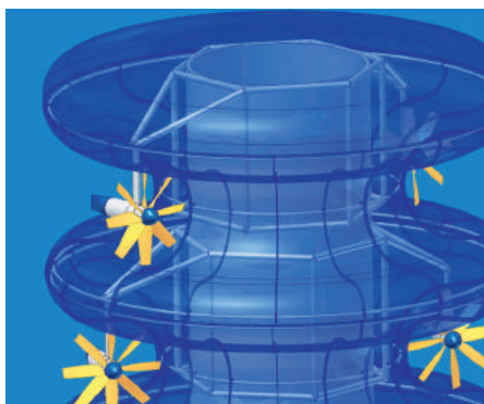
Les hélices, montées sur une structure mobile, s'orientent instantanément, comme une girouette.
