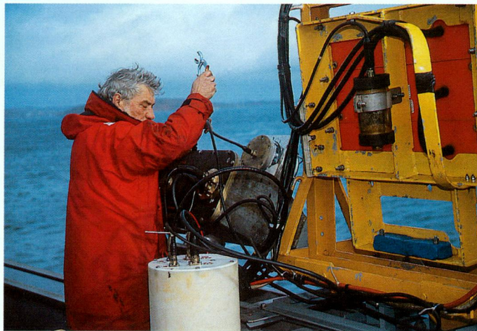
▲ Les sonars à tester sont fixés sur un chariot, qui translate horizontalement le long d'un rail, lui-même mobile verticalement pour multiplier le volume d'action des sonars...
