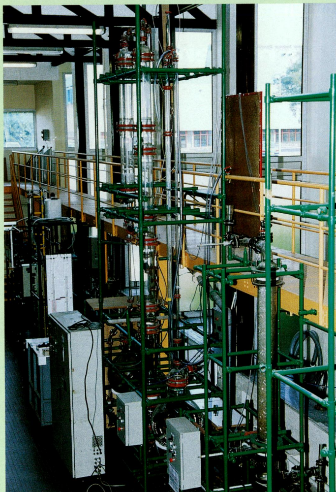
▲ Pendant leur formation, les étudiants sont sensibilisés au monde de l'entreprise, tant sur le plan théorique que pratique. Ici un pilote industriel (colonne de distillation), dans le hall "génie chimique" de l'ENSCR.
