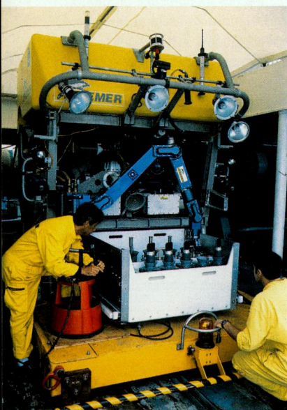
▲ Des techniciens testent le bras télémanipulateur du Rov.
