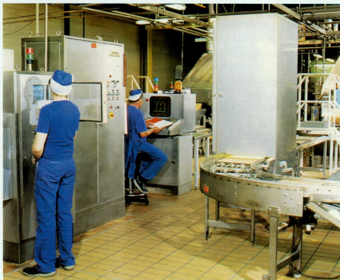
▲ Chez LU, près de Nantes, Edixia a installé un système de vision industrielle qui analyse les niveaux de gris des images des gaufrettes “Paille d’or” (degré de cuisson) et régule le fonctionnement du four.
