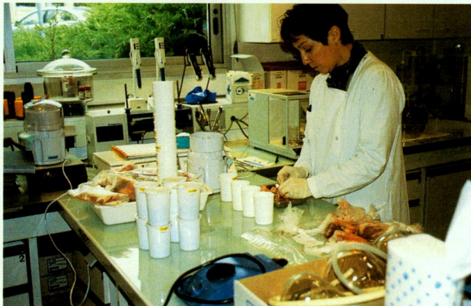
◀ Préparation d'échantillons de viande en vue d'une recherche chimique de chloramphénicol et de sulfamides.
