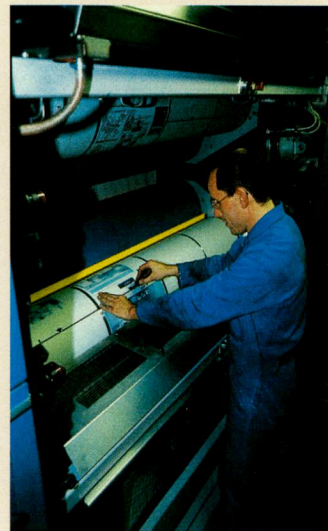
▲ Les plaques sont installées sur les cylindres de la rotative. Le cylindre intermédiaire recouvert de caoutchouc bleu est le blanchet.
