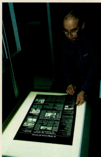
▲ Le film, fabriqué par une photocomposeuse est insolé sur une plaque de métal.
