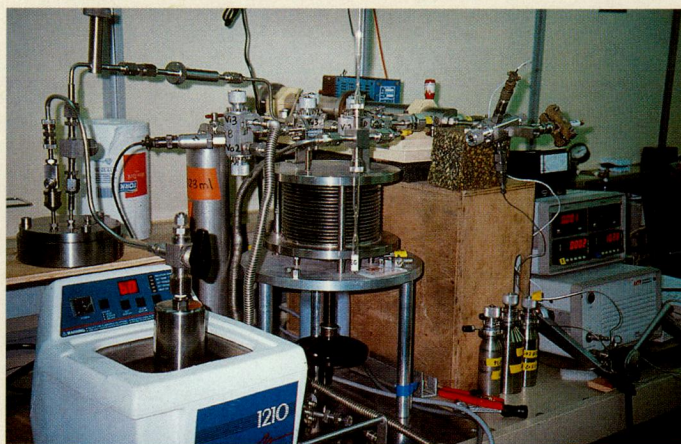
▲ Appareils d'extraction des gaz des fluides hydrothermaux, mis au point au laboratoire de géochimie de l'Ifremer, utilisés pour l'analyse des gaz collectés par le Shinkai 6500 dans le bassin de Manus.
