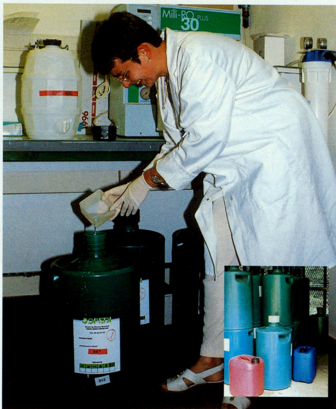
▲ La gestion raisonnée des déchets débute dans les laboratoires. Bleu, vert, rose... chaque type de container correspond à une catégorie de produits chimiques.
