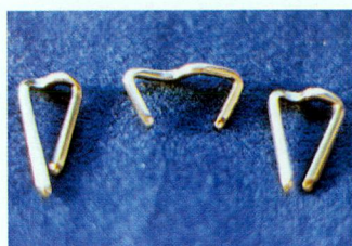
▲ Ces agrafes chirurgicales, conçues et commercialisées par la société Nogitek, sont dites à mémoire de forme chaude, car elles adoptent une position fermée après chauffage à 50°C. Elles sont utilisées pour réduire les fractures.
