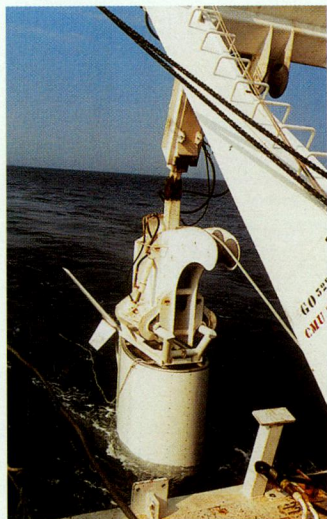
▲ Le "poisson" remorqué : la source d'émissions acoustiques.
