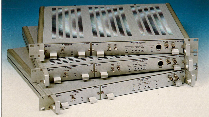
Système de transmission FM monocanal sur fibre optique (Thomlite FM 7600), comprenant un émetteur, un récepteur et un répéteur.
