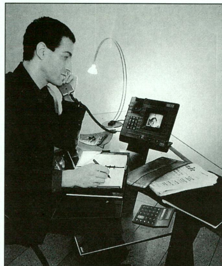
Terminal visiophonique intégrant un écran plat couleur à matrice active. Ce dispositif préfigure le visiophone qui pourrait être utilisé sur NUMERIS.
