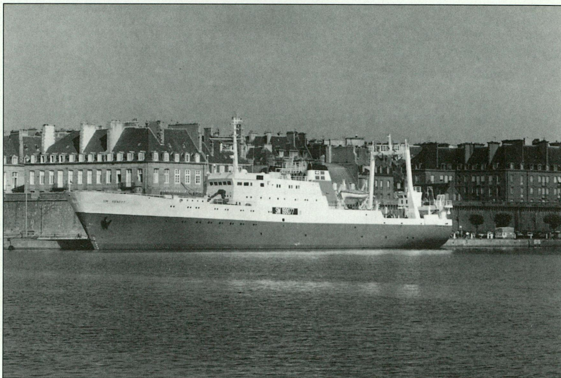
Un chalutier moderne : "Le Capitaine Pleven II", à Saint-Malo, à la fois navire, usine et entrepôt réfrigéré.
