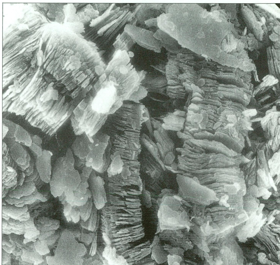
Plaquettes de kaolinite vues en microscopie électronique à balayage.
