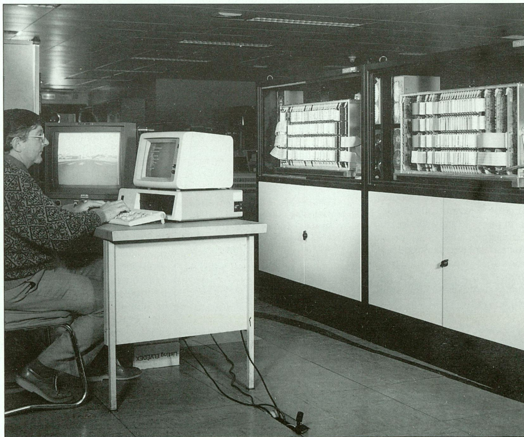
La Machine de Génération Synthétique d'Images G10K réalisée par la société SOGITEC est l'une des plus puissantes en Europe. Elle calcule 10 000 facettes en temps réel et affiche toutes les 40 millisecondes une image de 1 024 par 1 024 points. Cette machine est utilisée dans les simulateurs temps réel du CELAR (char, hélicoptère) pour la restitution visuelle de l'environnement extérieur.
