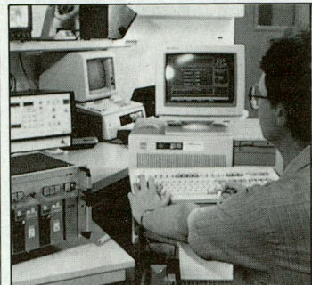
Photo : système de commande d'un fauteuil robotisé pour la radiothérapie.
