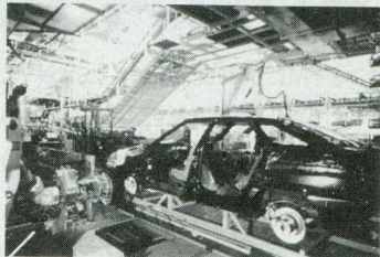
Pose robotisée des roues
