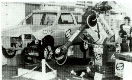
Une des attractions, le montage d'une roue sur un robot piloté par un système de vision (stand Edixia).
