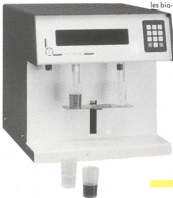
Ce compteur de globules permet sur un échantillon de sang total de calculer six paramètres avec les plaquettes.
